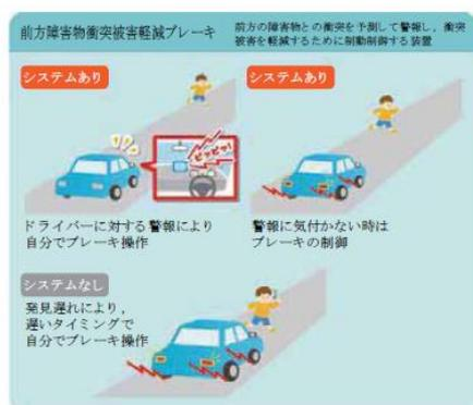
図7 衝突被害軽減ブレーキの概要<sup>8)</sup>
