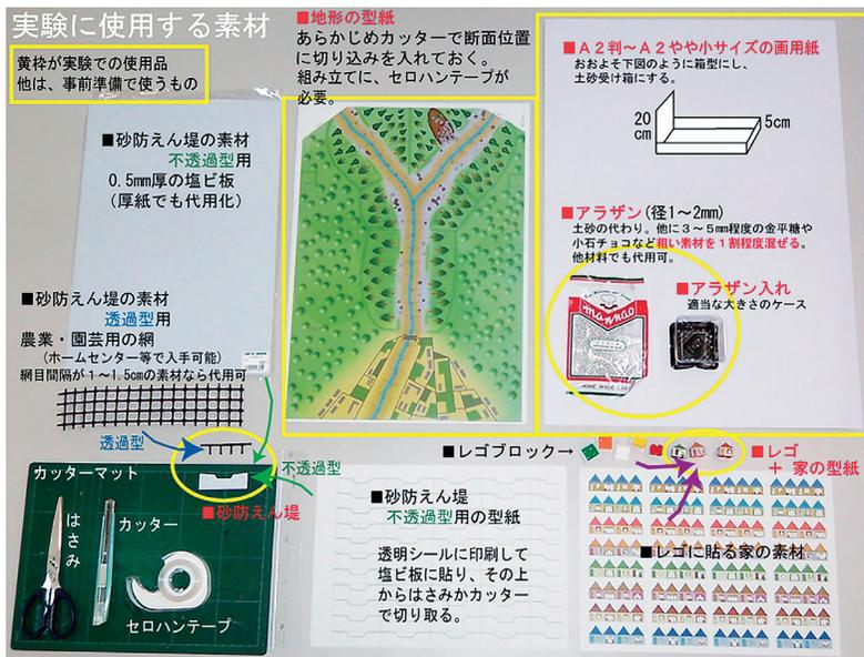
図2 簡易土流実験教材
